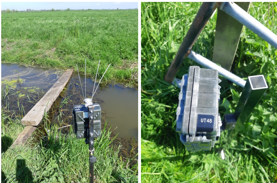
Figuur 2.3. Een cameraval in het veld. Elke cameraval heeft een eigen code, die ook op de foto is afgebeeld.
