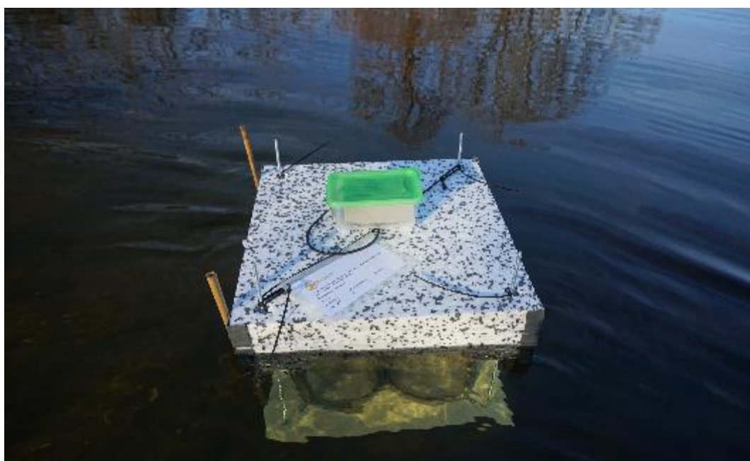
Figuur 3.1.6. Eén van de gebruikte lichtvallen tijdens het onderzoek 'pilot structuur- en lichtvallen voor de kwabaal' uitgevoerd in Nederland en Duitsland door Vos et al., 2020. Bron foto: Sanne Ploegaert.
