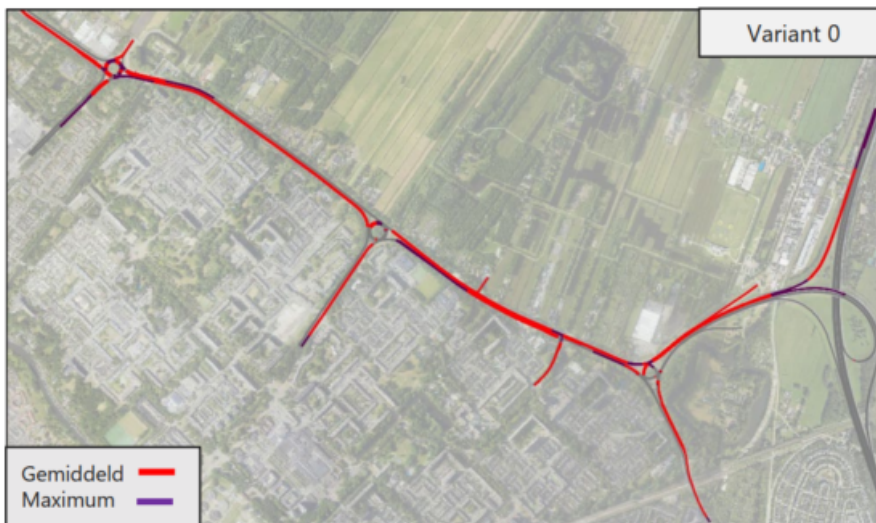
Afbeelding: het beeld van de gemiddelde ochtendspits in 2040 zonder aanpak van NRU. De rode lijnen geven stilstaand/langzaam rijdend verkeer weer tussen 7.00 en 9.00 uur. De paarse lijnen tonen de extra filevorming op piekmomenten in de spits.
