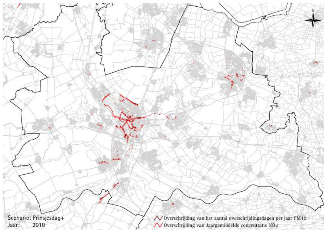
Figuur 4.8: NO 2 en PM 10 normoverschrijdingen in 2010 voor het Prinsjesdag + scenario langs het onderliggende wegennet in de provincie Utrecht
