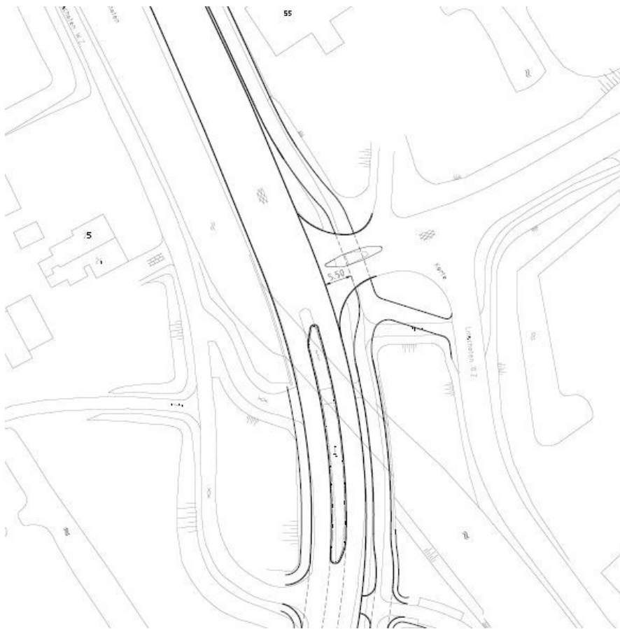
foto 2: verleggen fietspad over Van Rietlaan
