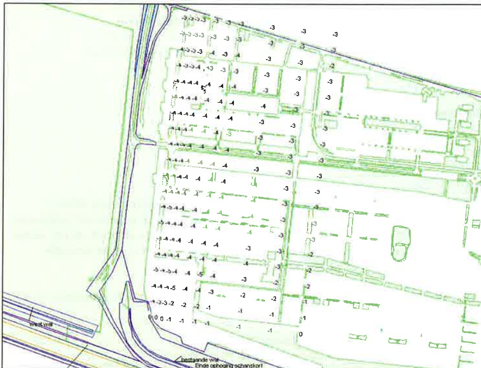
Figuur 1: Effect in dB op 8 meter hoogte bij aanleg geluidswal Woerden, inclusief scherm van 3 meter hoog en verhoogde kop bestaande wal
