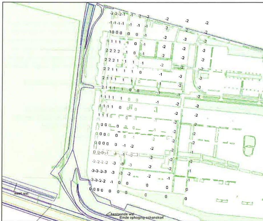
Figuur 4 : Verschil in effect (in dB) op 8 meter hoogte tussen de beoogde geluidswal Woerden en een geluidswal/scherm ten westen Veldhuizerweg.
