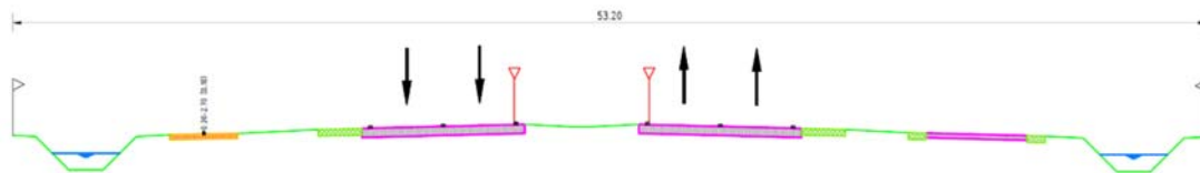
Denkrichting 2 - Principe dwarsprofiel Gebiedsontsluitingsweg wegtype I enkelbaansweg met 2x2 rijstrook Schaal 1:200
