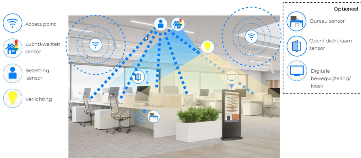
Figuur 27. Regeltechniek aanpassen voorbeeld.
