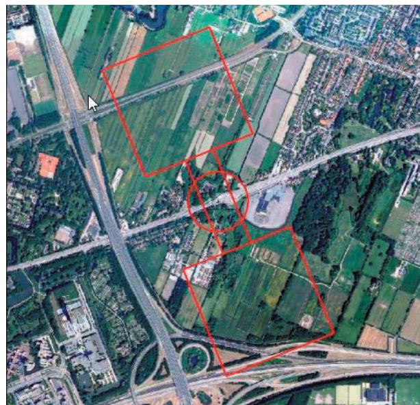
Fig. 1: 'Ruimtelijke randvoorwaarden ecopassage N-237 met zowel een buffer rondom de faunapassage ter hoogte van de Utrechtseweg (met een straal van 150 m), een ecologische corridor (met een breedte van 150 m) en een stepping stone/stapsteen (met een oppervlakte aan noord- en zuidzijde van 33 ha) (uit: 'Alterra-rapport')
