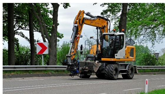
Figuur 5: mobiele graafmachine (MMBS of MM) (bron: CROW).
