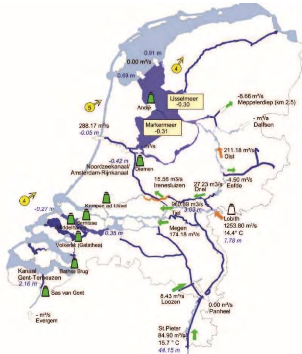
Figuur 9 Voorbeeld van een informatiescherm: Weergave uit het informatiescherm van het hoofwatersysteem met data over afvoer en chloridegehalte
