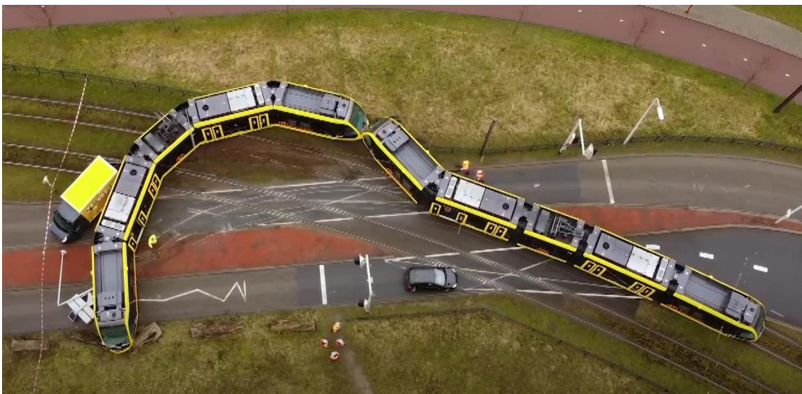
Foto 1: Drone-opname van de situatie kort na de ontsporing. In het wegdek zijn de sporen van de wielen onder de eerste rijtuigbak zichtbaar. (Bron: NU.nl).
