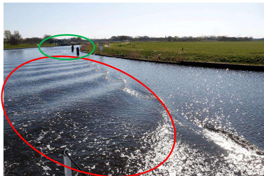
Figuur A.6: secundaire scheepsgolven opgewekt bij een vaarsnelheid van ca. 12 km/uur. Op de achtergrond zijn de reflecties zichtbaar.
