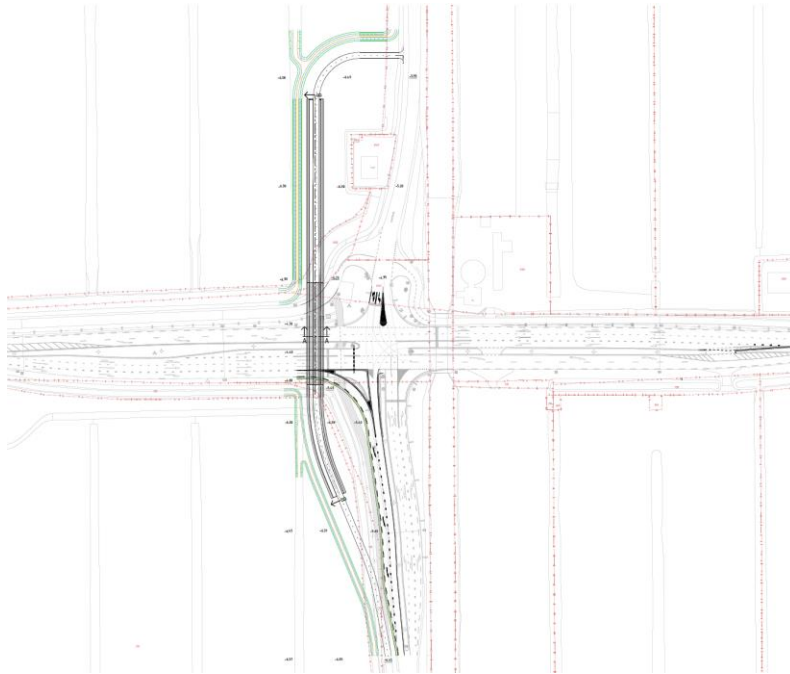
Figuur 4.5. Schetsontwerp van de voorkeursvariant fietstunnel N212 noord-zuid
