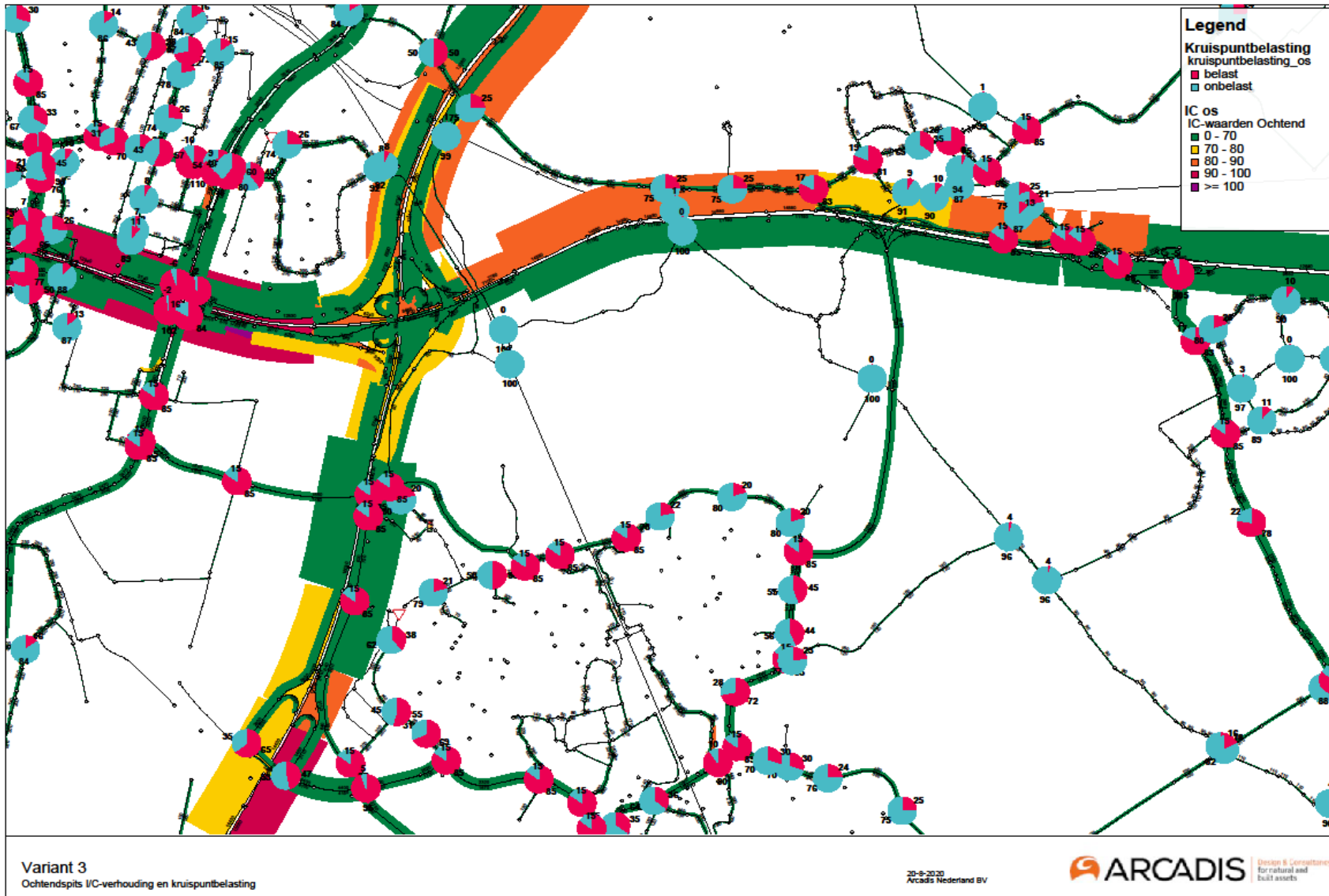
Figuur 37 I/C-verhouding en kruispuntbelasting Infrastructuurvariant 3 Ochtendspits
