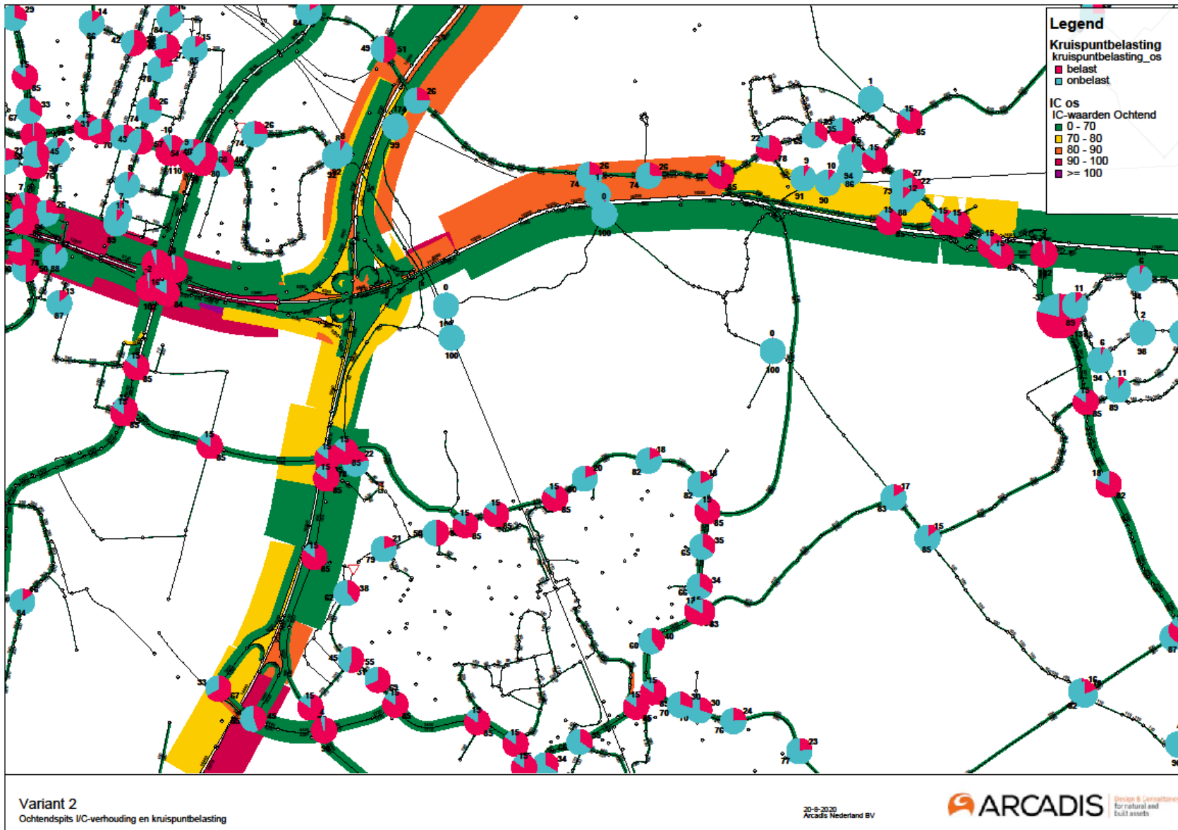
Figuur 35 I/C-verhouding en kruispuntbelasting Infrastructuurvariant 2 Ochtendspits
