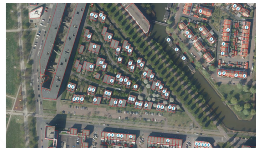
Figuur 2: Detectie zonnepanelen o.b.v. luchtfoto
