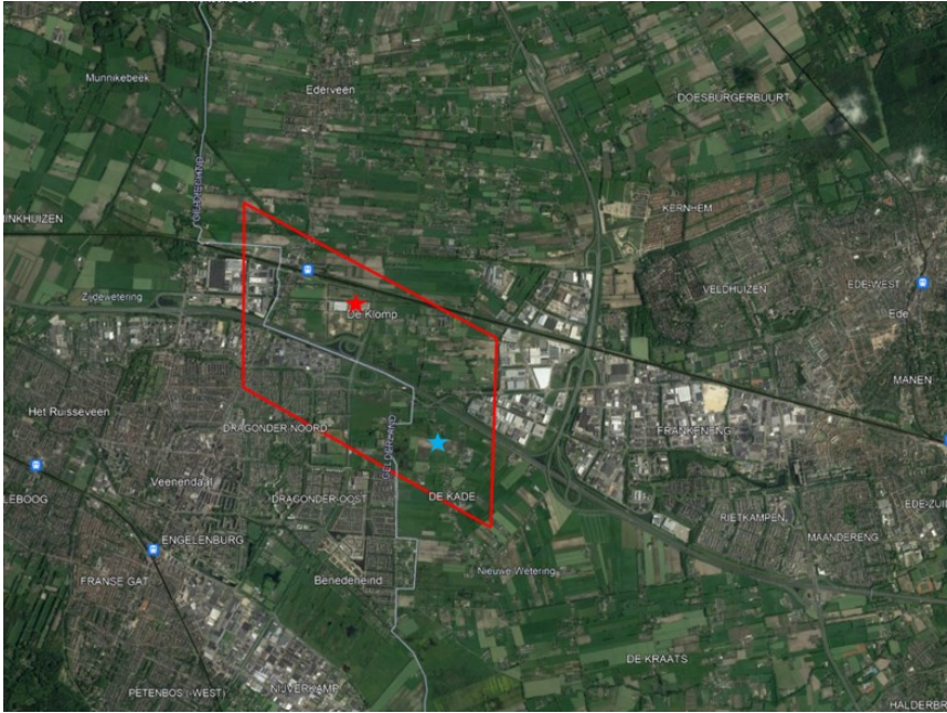
Figuur 1: Ligging gebied aanvraag startvergunning wetenschappelijke boring aardwarmte Ede-Veenendaal (rode lijn) met de twee mogelijke locaties voor de boring (rode en blauwe ster). De provinciegrens Utrecht-Gelderland is met een grijze lijn aangegeven.
